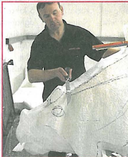
Ein Mitarbeiter schneidet aus Styropor das Modell zurecht (Bild links). Ist das Tier in Form gegossen, geht es mit Lack und Farbe an die Details (Bild rechts). Fotos: Wolterdesign
